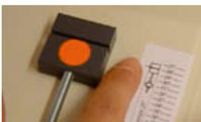
La fixer dans le fond du socle, parallèlement à la graduation, le taquet gris orienté vers le haut, grâce aux visse moyennes (4) et aux écrous de serrage.
